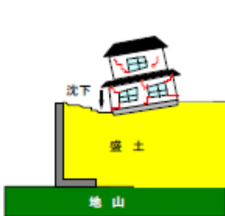
盛土の締め固め不足
