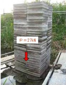
水を吸水でき軟弱地盤での施工性良好
