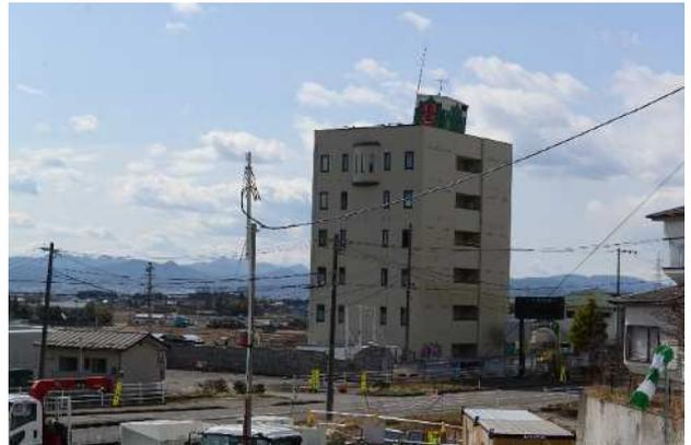
写真-3 国見町の国道4号沿いの人家の屋根瓦の落下とビルの傾斜(転倒の危険有り)
