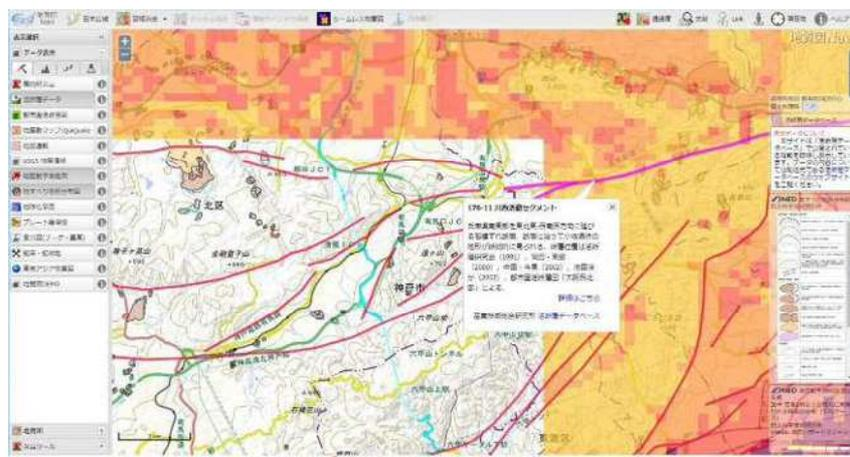
活断層図、地震動予測地図、地すべり地形分布図を表示した例
