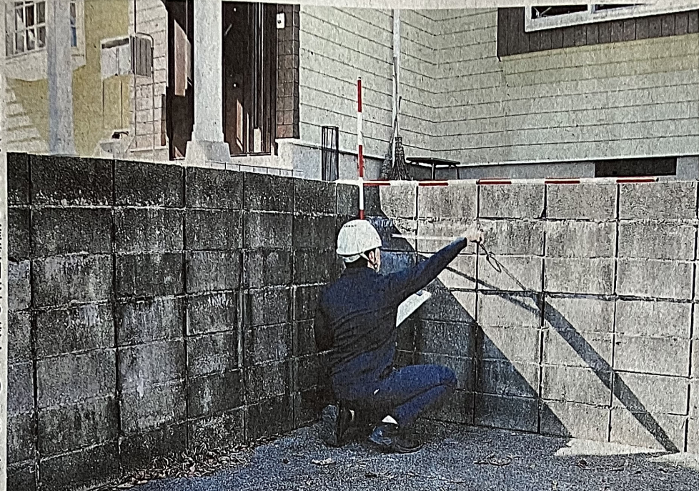
地盤品質判定士による擁壁調査の様子＝10月28日、宇城市(地盤品質判定士会九州支部提供)
